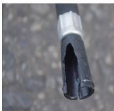
× ノズルの破損
