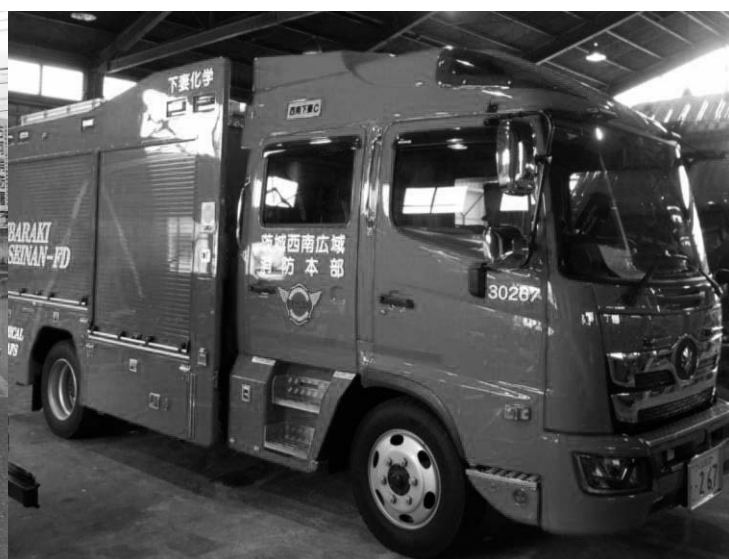
災害対応特殊化学消防ポンプ自動車【I型】C A F S装置付 (平成30年度下妻・坂東化学車更新)
