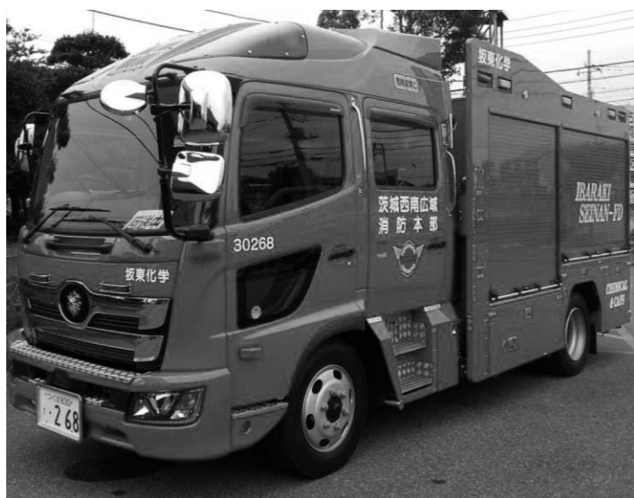
災害対応特殊化学消防ポンプ自動車【I型】C A F S装置付 (平成30年度下妻・坂東化学車更新)
